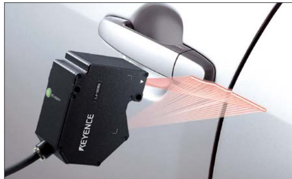
Confirmación de la precisión del montaje de una puerta/cubierta
